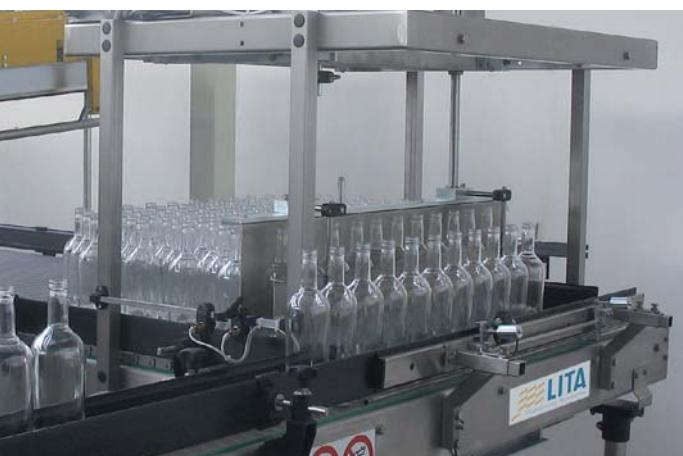
Machine semi-automatique avec système par préhension des couches.
